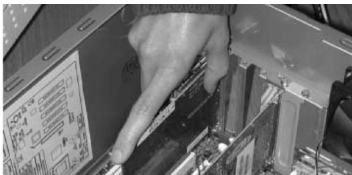
Darstellung 2.1: Einsetzen der DVB-Karte in einen freien PCI-Slot
