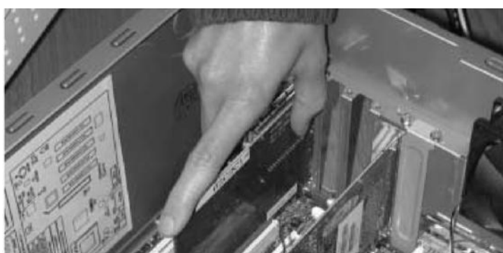
Figure 2.1 : Insertion de la carte DVB dans un slot PCI
